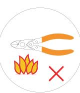
**Nunca aumentar o comprimento dos cabos dos alicates. Isto amplifica a força exercida sobre a cabeça do alicate, podendo quebrá-lo.**
