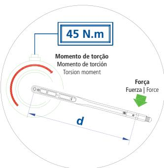
Assim, o cálculo geral do Momento de Torção ou Torque é descrito por | Así, el cálculo global del momento de torsión o torque se describe por | The general calculation for the Torsion Moment or Torque is:
